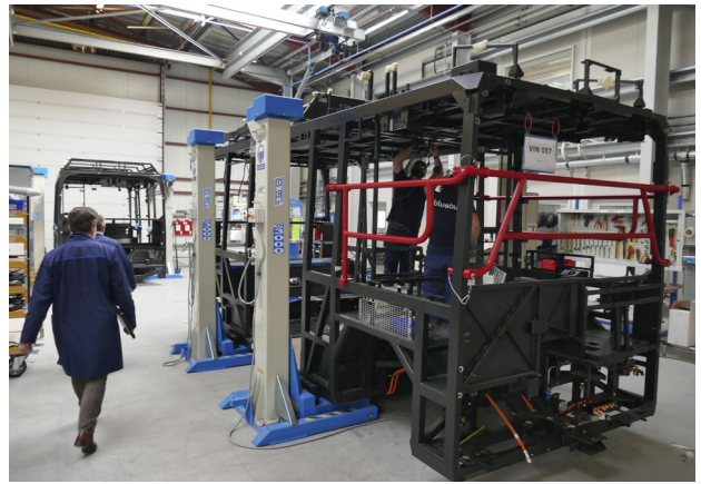
L'USINE BLUEBUS DISPOSE D'UNE CAPACITÉ DE PRODUCTION POUVANT VARIER DE 50 À 400 VÉHICULES/AN.
