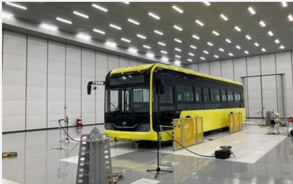
L'industriel dispose d'un banc de test « son » pour tous les modèles de sa gamme.
