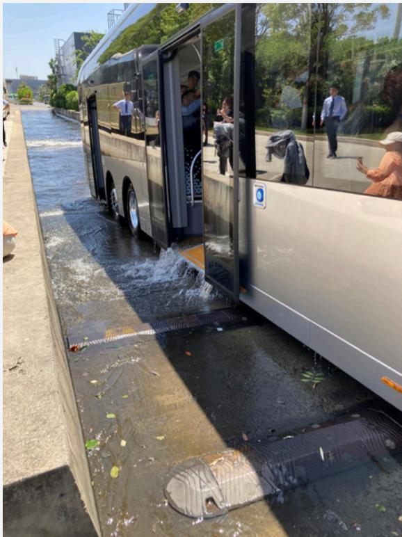
Les batteries qui équipent les autobus électriques de Yutong sont installées sur le toit, une occasion pour le constructeur de prouver la validité de ce choix, en montrant qu'un U12 Elec peut traverser une piscine, sans altération de son fonctionnement.
