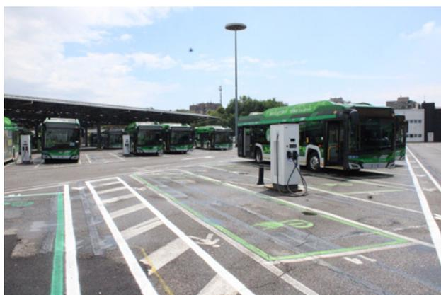
PLUSIEURS BUS ÉLECTRIQUES STATIONNÉS AU DÉPÔT DE SAN DONATO. A NOTER LES OMBRIÈRES FOURNISSANT VIA DES PANNEAUX SOLAIRES DE L'ÉLECTRICITÉ UTILISÉE POUR LA RECHARGE DES BUS.
