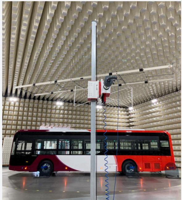
Dans un univers qui se complexifie en matière de connectivité, le banc test électro-magnétique permet de vérifier le bon fonctionnement de tous les composants électroniques des véhicules, au même titre que leur interaction.
